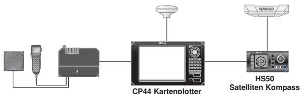
Abb. 3.11 - Beispiel von multiplen Datenquellen in einem SimNet System
