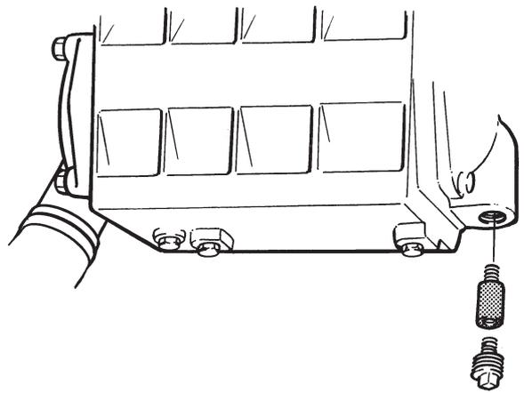
TAMD63, TAMD73 und TAMD74: Zinkanode im vorderen Enddeckel des Wärmetauschers
